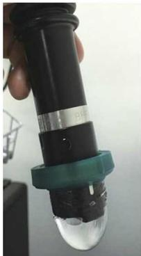
图 1 水囊式 UBM 探头
